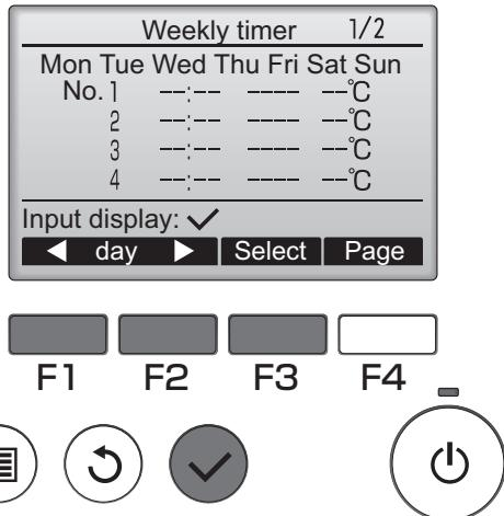
Prikazat će se zaslon za postavljanje weekly timer (tjednog timera) a trenutne postavke će biti prikazane. Za svaki se dan može postaviti do 8 uzoraka načina rada.
