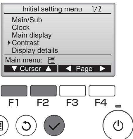
Pomaknite kurzor na "Contrast" (Kontrast) pomoću tipke **F1** i **F2**, te zatim pritisnite tipku **odabir**.
