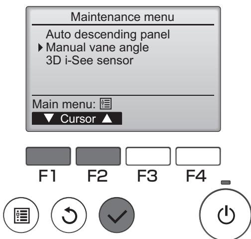
Odaberite "Manual vane angle" (Ručno namještanje kuta krilca) pomoću tipke **F1** ili **F2**, te pritisnite tipku **odabir**.
