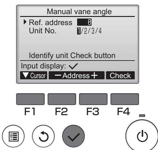
Pomaknite kurzor na "Ref.address" (Referentna adresa) ili "Unit No." (Br. uređaja) pomoću tipke **F1** za odabir. Odaberite postavku rashladnog sredstva i broj uređaja za uređaje na čija se krilca moraju pričvrstiti, pomoću tipki **F2** ili **F3** te zatim pritisnite tipku **odabir**.
