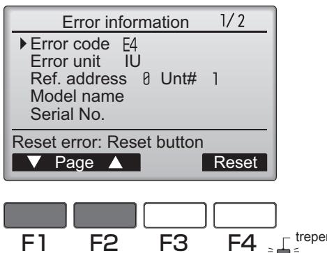
Šifra greške (Error code), jedinica greške (error unit), postavka raskladnog sredstva (Ref. address), naziv modela (model name) te Serijski broj (Serial No.) bit će prikazani.
