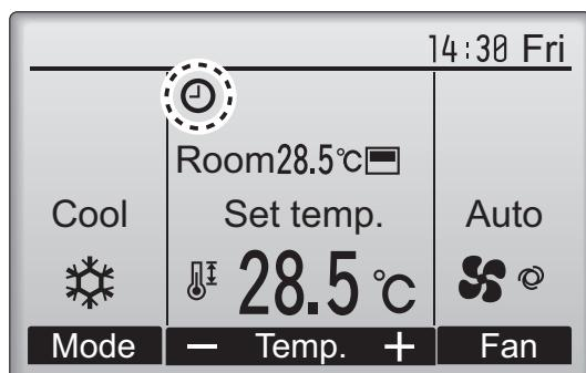
⌚ će se prijaviti na Glavnom izborniku u Full načinu rada kada je On/Off timer (Uključen/Isključen timera) dostupno.
