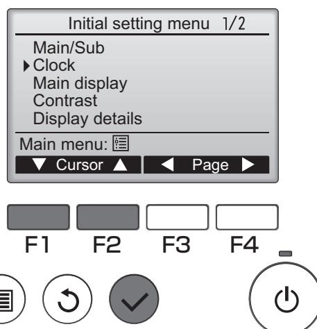
Pomaknite kurzor na "Clock" (Sat) pomoću tipke **F1** i **F2**, te zatim pritisnite tipku **odabir**.
