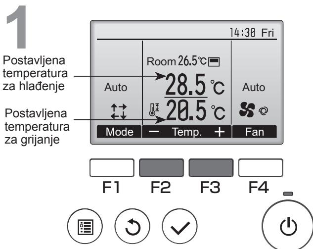
Pojavit će se trenutno postavljene temperature. Pritisnite tipke **F2** ili **F3** za prelazak na zaslon Postavki.
