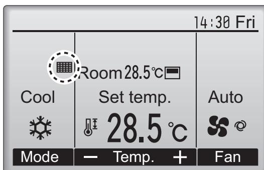
će se prijaviti na Glavnom izborniku u Full načinu rada kada je potrebno očistiti filtre.
