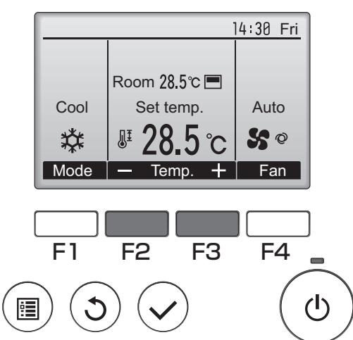
Pritisnite tipku **F2** za smanjivanje postavljene temperature, i tipku **F3** za povećavanje.
