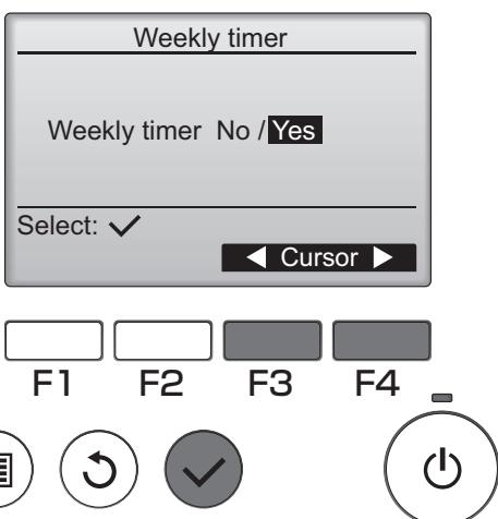
Prikazat će se zaslon za aktivaciju (Yes) ili deaktivaciju (No) weekly timer (tjednog timera).
