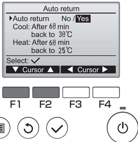
Prikazat će se zaslon za postavljanje funkcije automatskog povratka na prethodno postavljene temperature.
