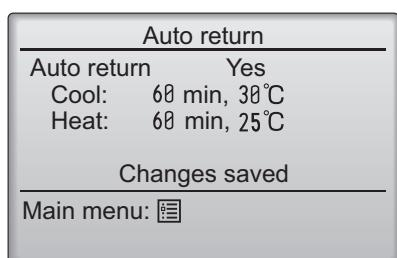
Pritisnite tipku **odabir** za pohranjivanje postavki. "Cool" (Hlađenje) uključuje "Dry" (Sušenje) i "AUTO Cooling" (Automatsko Hlađenje), a "Heat" (Grijanje) uključuje način rada "AUTO Heating" (Automatsko Grijanje).
