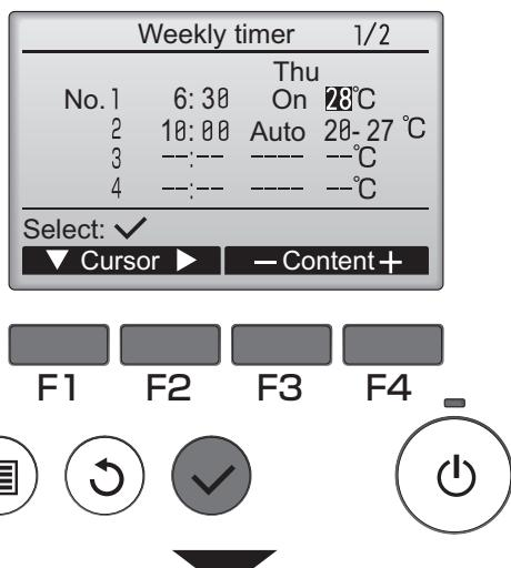
Prikazat će se zaslon za odabir obrasca rada. Pritisnite tipku **F1** za pomicanje cursora na željeni broj predloška.
