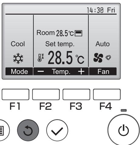
Pritisnite tipku **povratak** za izlaz iz Main menu (Glavnog izbornika) i povratak na Glavni izbornik.
