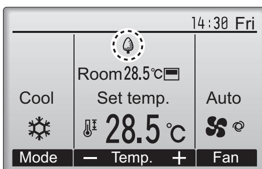
Će se prikazati na Glavnom izborniku u Full načinu rada kada se uređajem upravlja u načinu rada za štednju energije.
