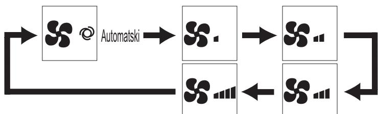
• Dostupne brzine ventilatora ovise o modelima povezanih unutarnjih uređaja.
